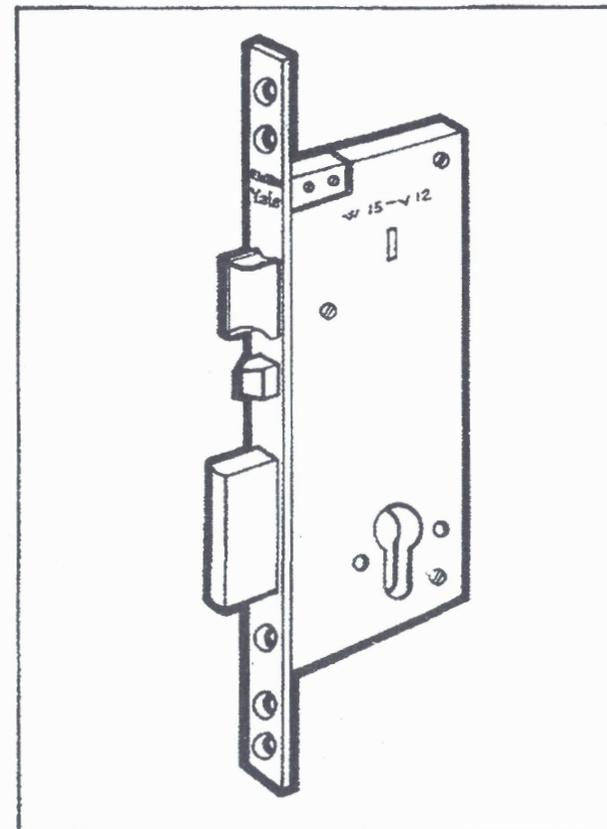
Collegamento elettrico: alimentare esclusivamente mediante trasformatore di potenza 15 Watt e tensione di uscita 12 Volt.
